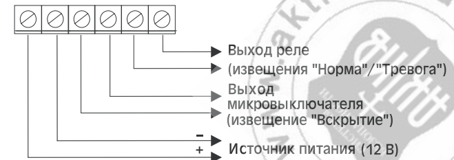
Схема подключения извещателя
