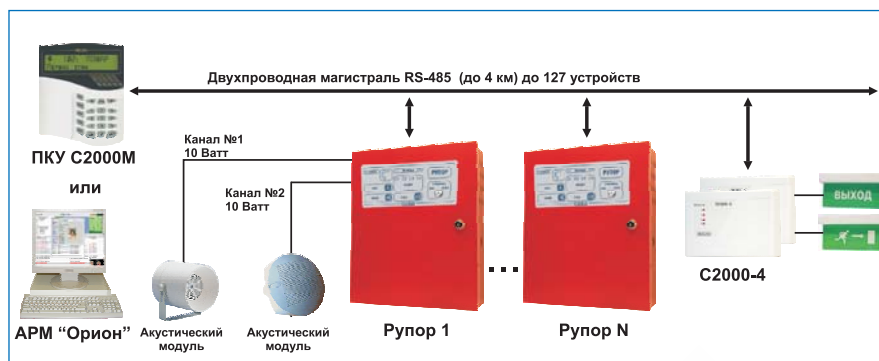
Схема включения «Рупор» в составе ИСО «Орион»
